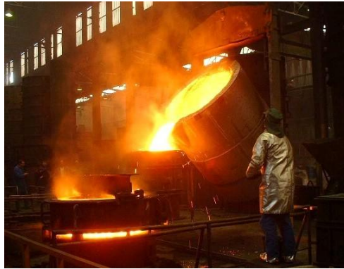
Gambar 2.20 Tungku Pengecoran (Maria Jaya, 2021).
