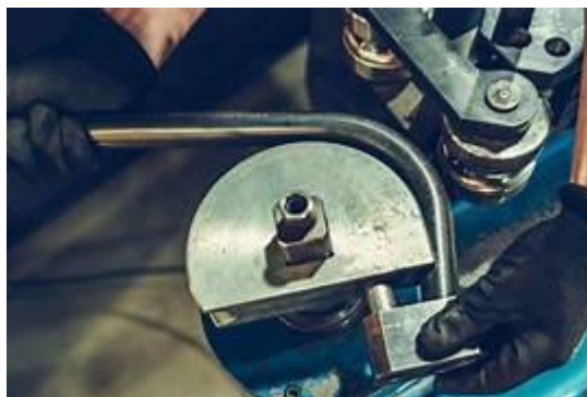
Gambar 2.1 Pembengkokan Pipa (Bending) (Shane, 2023)
