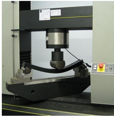
Gambar 2. 33 Pengujian Lengkung (Rizki, 2020)
