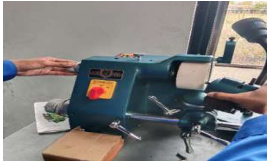
Gambar 3.24 Seting jarak mata bor dengan permukaan batu grinda
