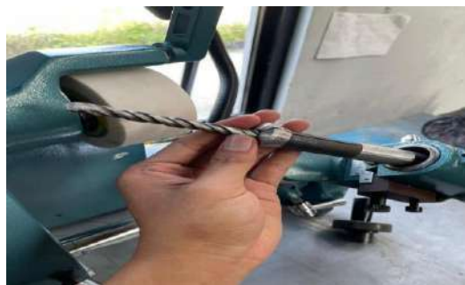
Gambar 3.19 Pemasangan Pada Collet
