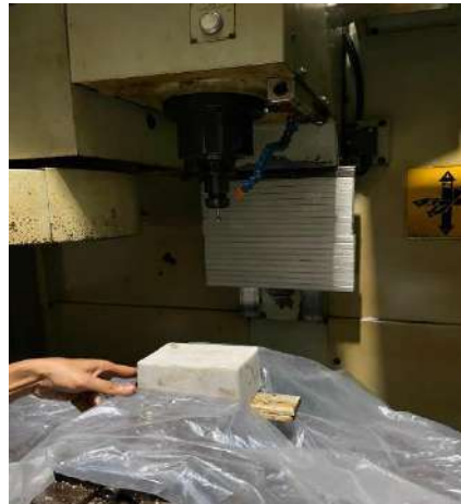
Gambar 3.52 Memasang Benda Kerja Pada Ragum
