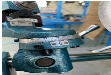
Gambar 3.22 Sudut Arah Posisi Tailstock
