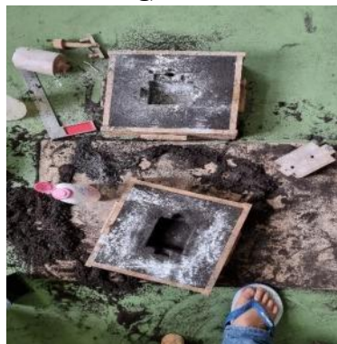
Gambar 2.2 Pengecoran Pasir (Perwira, 2022)
