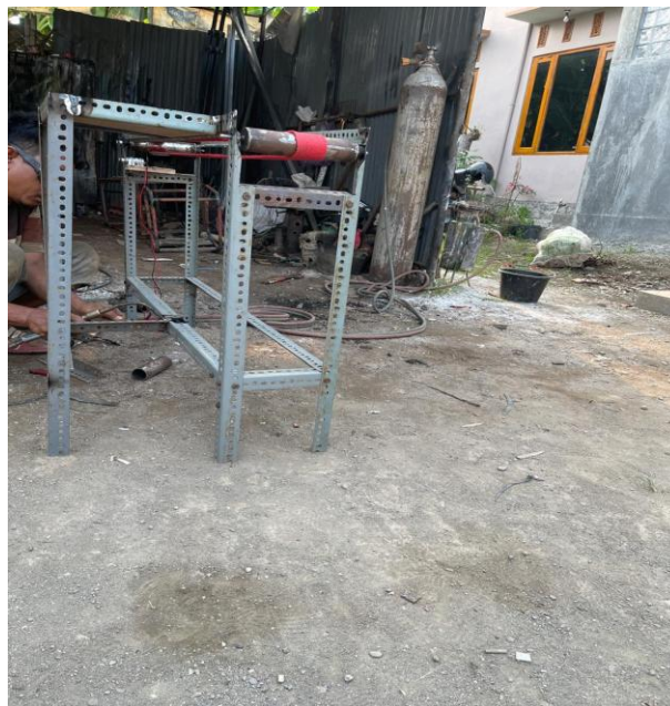
Dokumentasi pengelasan rangka sebelah
