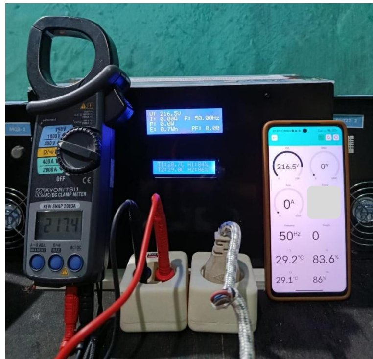
Gambar 4.2 Pengukuran tegangan menggunakan multimeter
