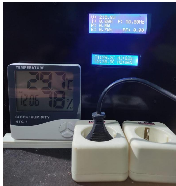
Gambar 4.4 Pengukuran suhu dan kelembapan dengan termometer digital
