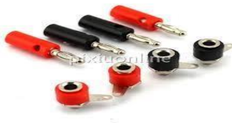
Gambar 2. 9 Banana connector dan socket
