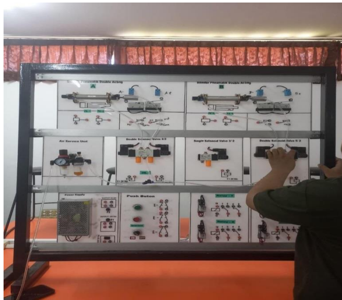
Gambar 4. 10 Tampilan Hardware gerakan silinder B dari B+ menuju B-
