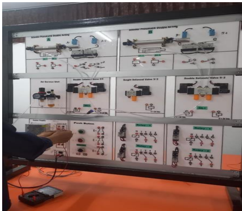
Gambar 4. 3 Pengecekan Power Suplay
