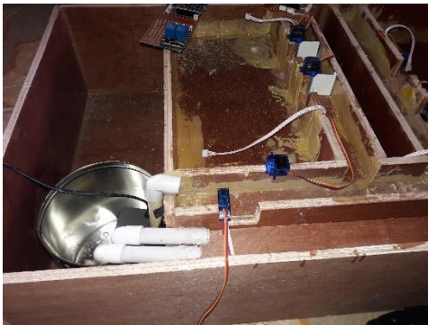
Proses instalasi kabel dan motor servo pada rangka prototype
