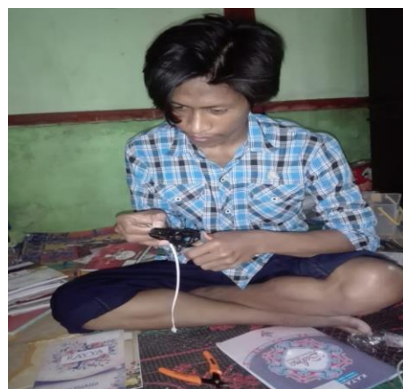
Proses pemasangan pin conector pada kabel
